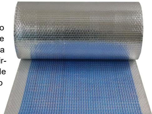
**AIR-BUR CM XPS 20, AIR-BUR CM XPS 30, AIR-BUR CM XPS 40, AIR-BUR CM XPS 50, AIR-BUR CM XPS 60 y AIR-BUR CM XPS 80:** Sistema aislante termoacústico reflectivo compuesto por una lámina de aluminio encerrada por una capa de burbuja de aire seco estanco y de una plancha de Poliestireno Extruido (XPS). El sistema es suministrado por separado, para su instalación in-situ. No requiere cámara de aire.
