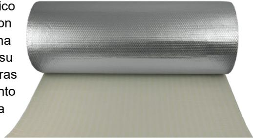
**Air-bur Termic PT (€/ml):** Sistema aislante termoacústico reflectivo para puentes térmicos, compuesto por una lámina de aluminio puro y una burbuja de aire seco estanco con una malla de fibra de vidrio para enlucir morteros o yeso. La Instalación Air-bur Termic PT requiere cámaras de aire. Además, se puede combinar con un aislamiento tradicional (XPS, MW, ...) logrando aumentar la equivalencia térmica.
