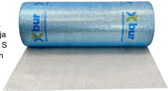
**Air-bur Termic S Adhesivo:** Sistema aislante termoacústico reflectivo de bajo espesor para placas y puentes térmicos con adhesivo, compuesto por una lámina de aluminio puro y una burbuja de aire seco estanco y un film adhesivo para su instalación. La Instalación Air-bur Termic S requiere cámaras de aire. Además, se puede combinar con un aislamiento tradicional (XPS, MW, ...) logrando aumentar la equivalencia térmica.
