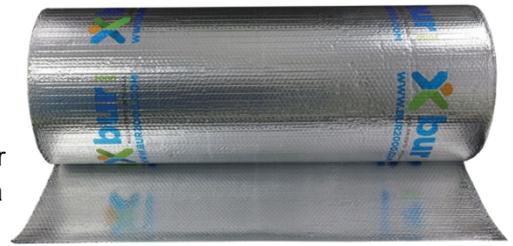
**Air-bur Termic S-YC:** Sistema aislante termoacústico reflectivo de bajo espesor compuesto por una lámina de aluminio puro encerrada en el interior de una burbuja de aire seco estanco y una espuma de polietileno. La Instalación Air-bur Termic S-YC no requiere cámaras de aire. Además, se puede combinar con un aislamiento tradicional (XPS, MW, ...) logrando aumentar la equivalencia térmica.
