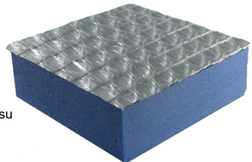
**AIR-BUR CM XPS 24, AIR-BUR CM XPS 34, AIR-BUR CM XPS 44, AIR-BUR CM XPS 54, AIR-BUR CM XPS 64 y AIR-BUR CM XPS 84:** Sistema aislante termoacústico reflectivo ya adhesivado, compuesto por una lámina de aluminio encerrada por una capa de burbuja de aire seco estanco y de una plancha de Poliestireno Extruido (XPS). El sistema es suministrado por separado, para su instalación in-situ. No requiere cámara de aire.
