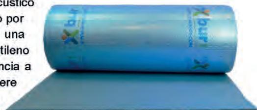
**Air-bur Termic S:** Sistema aislante termoacústico reflectivo de bajo espesor para placas y puentes térmicos, compuesto por una lámina de aluminio puro y una burbuja de aire seco estanco. La Instalación Air-bur Termic S requiere cámaras de aire. Además, se puede combinar con un aislamiento tradicional (XPS, MW, ...) logrando aumentar la equivalencia térmica.
