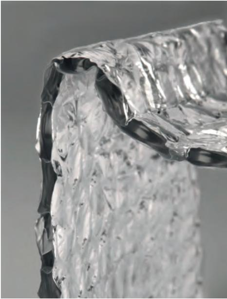
El aislante Termo Reflectivo **AIR-BUR TERMIC 10** se presenta como un sistema de aislamiento formado por la combinación por termofusión de dos láminas de aluminio puro que encierran a una capa de burbujas de polietileno de baja densidad , teniendo por tanto, un gran porcentaje de aire encerrado en su interior.
